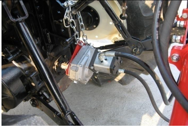
Slika 2. Hidraulična pumpa priključena na izlaznom vratilu traktora
