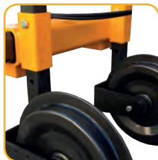
Ruote posteriori con cresta a regolazione altezza meccanica Rear wheels with mechanical adjustment
