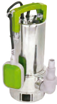
Submersible pump / Potopna pumpa AGRINA Q1100B67 1100W; 10.5m; 7m; 1.05bar; 16500l/h; 30.8kg
